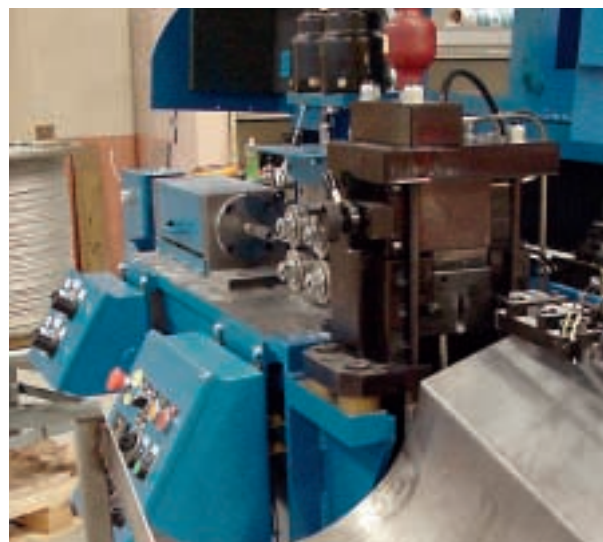
Morphics kapenhet monterad i ett riktverk från en amerikansk tillverkare ger en unik maskin som kombinerar riktverkets förmåga att rikta styv tråd med Morphics kapprestanda.
